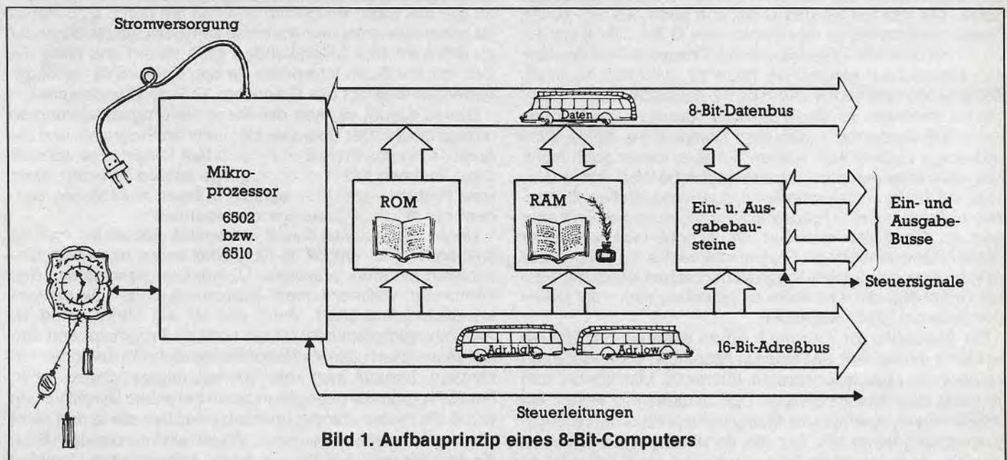
Bild 1. Aufbauprinzip eines 8-Bit-Computers
